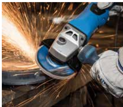
Зачистка сварных швов
