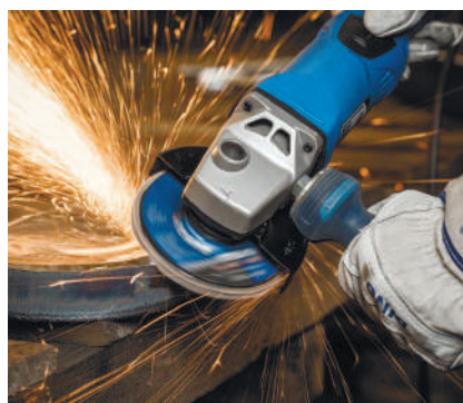
Зачистка сварных швов и обработка кромок
