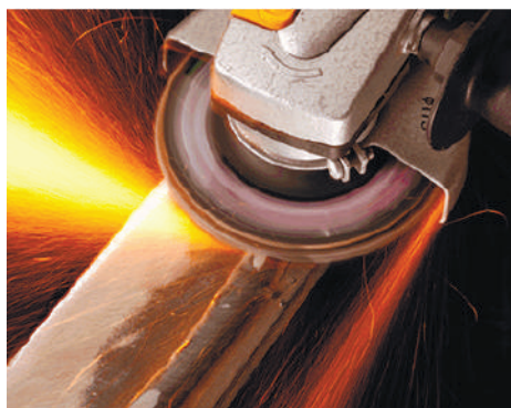
Зачистка сварных швов
